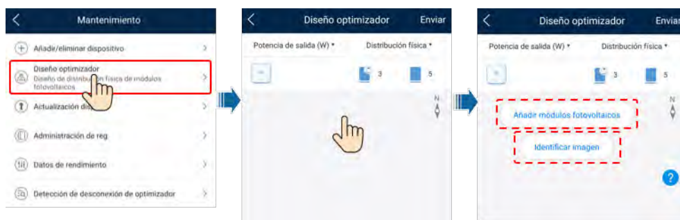
Figura 7-7 Diseño físico de los módulos fotovoltaicos
