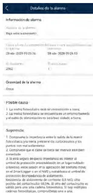
Figura E-1 Detalles de alarma
